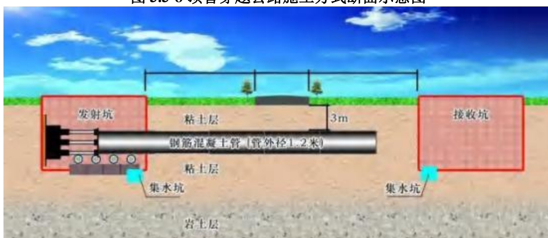
图 3.3-9 顶管施工工艺示意图
