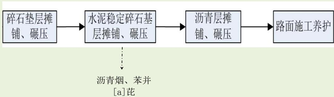
图3.6-3 沥青路面施工工艺及产污流程
