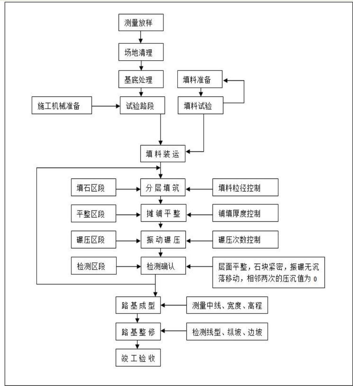
图3.6-2 路基施工流程图
