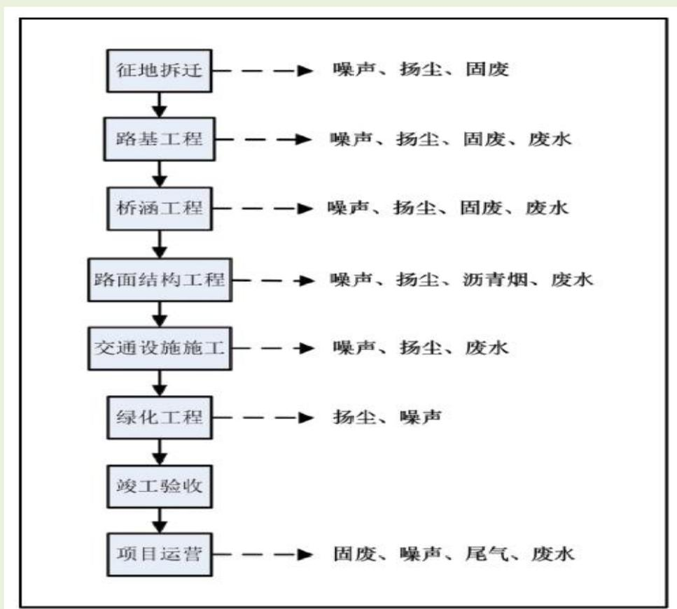
图3.6-1 本项目工程工艺流程及主要产污节点示意图
