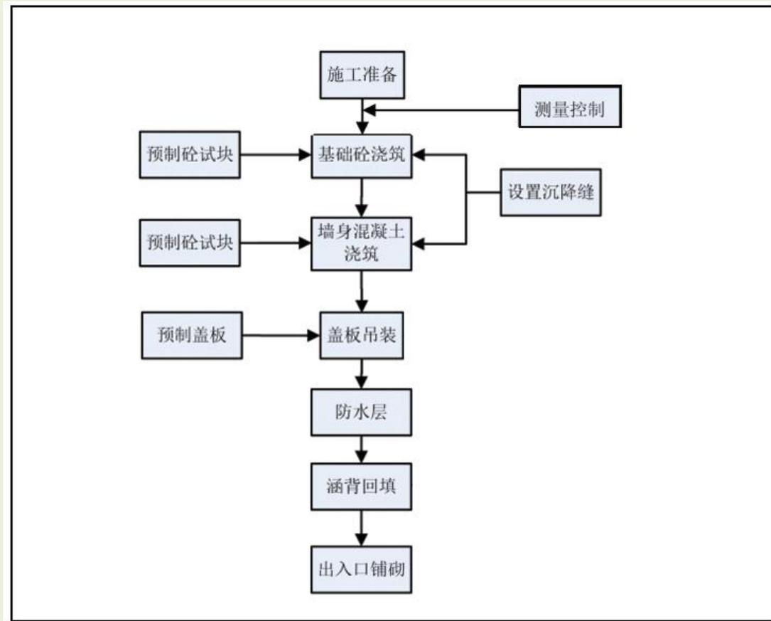
图3.6-4 盖板涵施工工艺流程图
