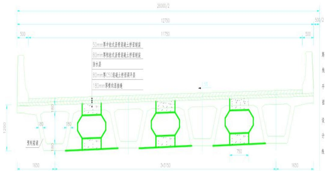
**图 3.1-5 桥梁标准横断面图（小箱梁）**
