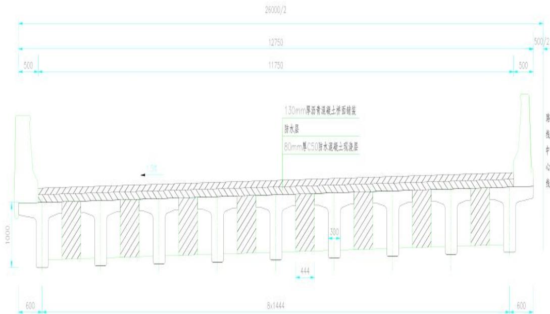
**图 3.1-6 桥梁标准横断面图（矮 T 梁）**
