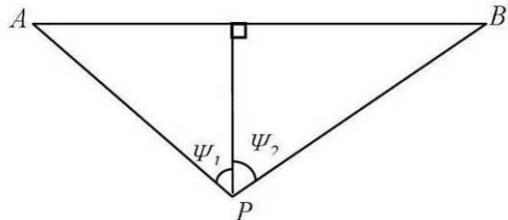
图5.3-1 有限路段的修正函数，A—B为路段，P为预测点
