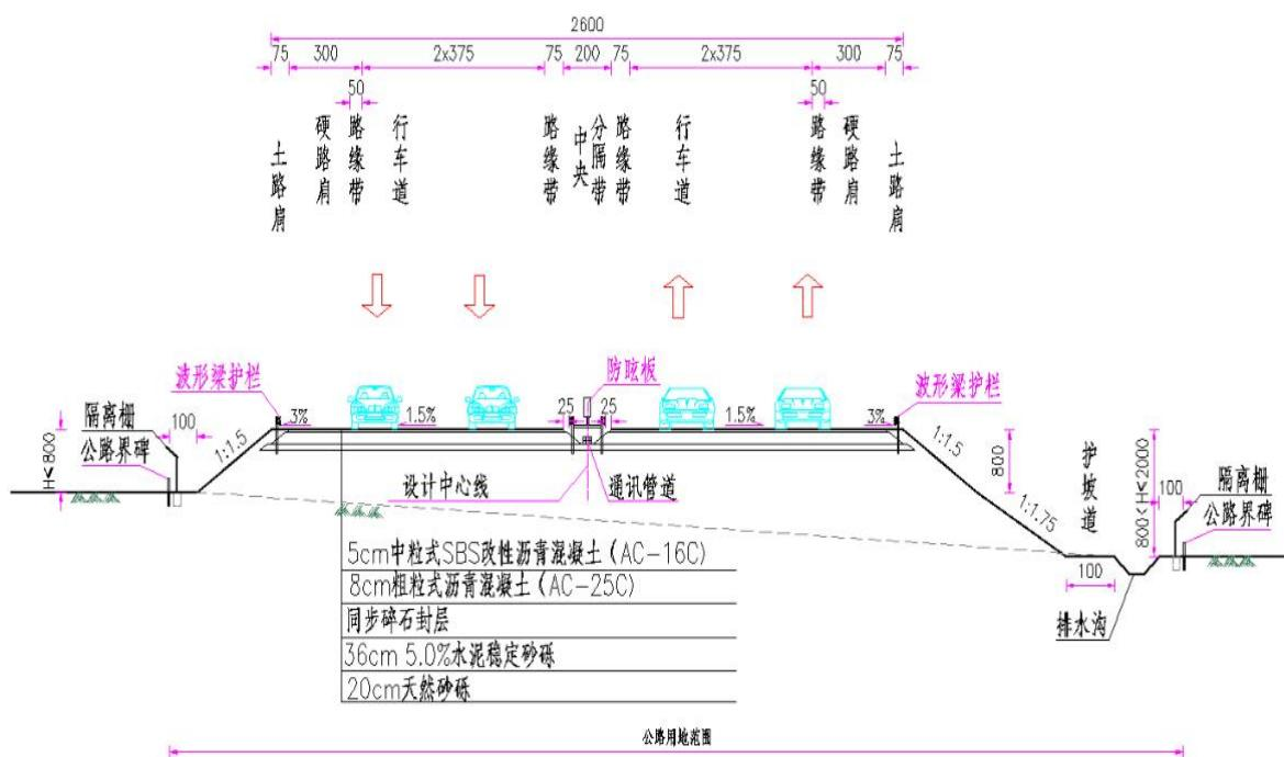
图 3.1-3 双向四车道 26m 宽一般路基标准横断面图
