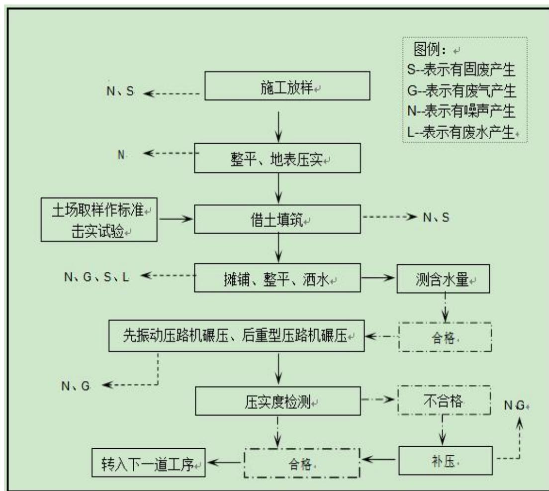
图 3.2-1 路基施工工艺流程及产污环节框图
