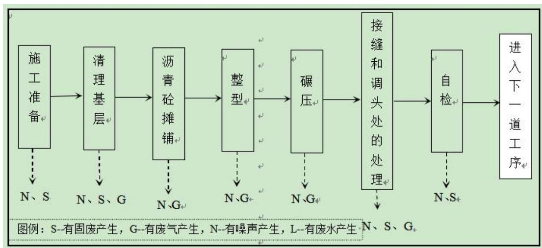
图 3.2-2 路面施工工艺流程及产污环节框图
