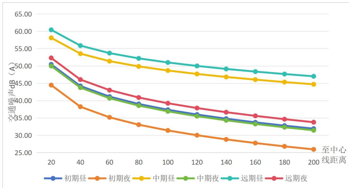
图5.3-8 连接线段段交通污染曲线图
