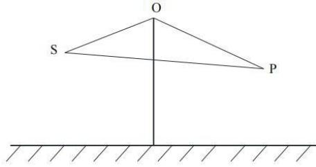
图5.3-3 无限长声屏障示意图
