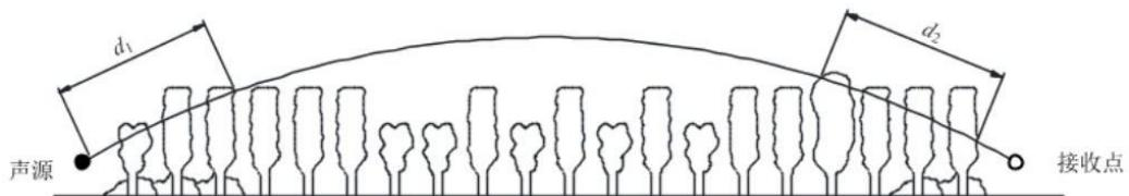
图 5.3-5 通过树和灌木时噪声衰减示意图
