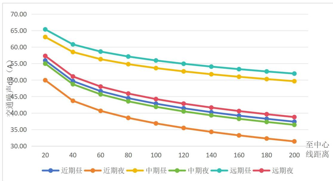
图5.3-7 K0+000-K10+309段交通污染曲线图
