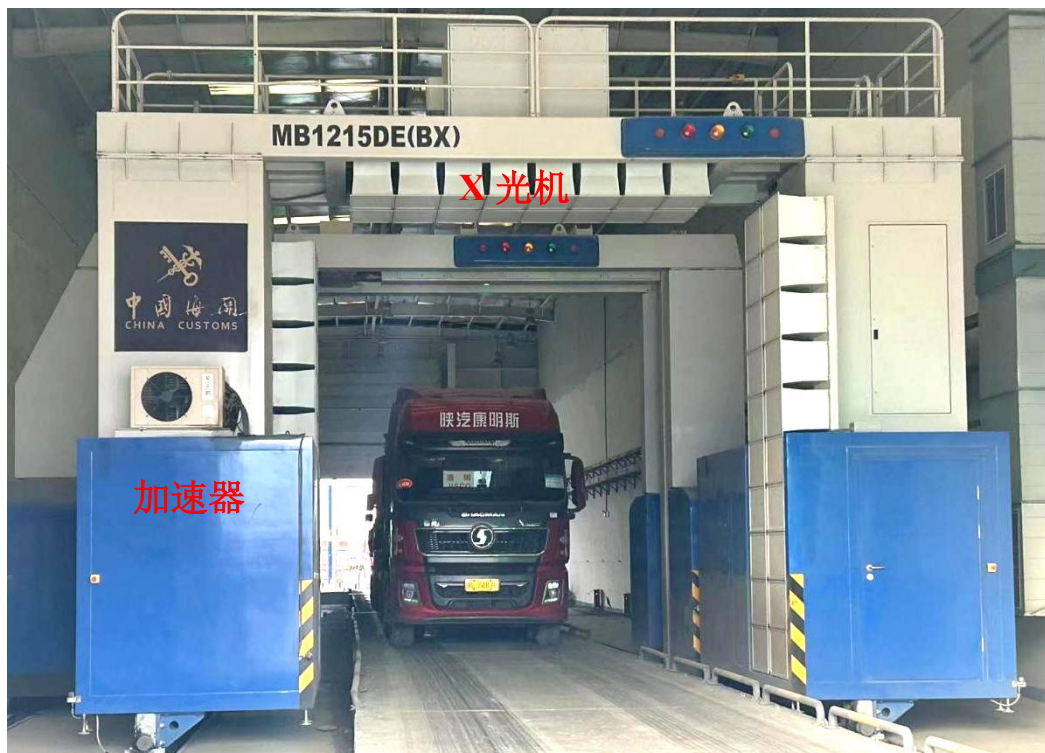
图 9-1 MB1215DE (BX) 组合移动式集装箱/车辆检查系统外观示意图
