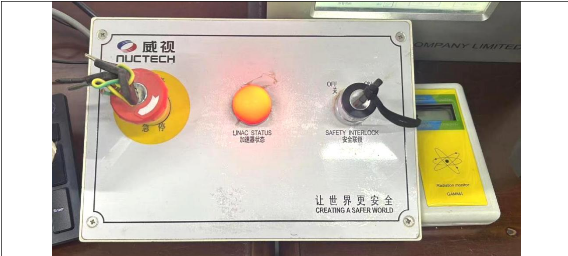
图 10-4 检查系统控制台上安全联锁开关示意图
