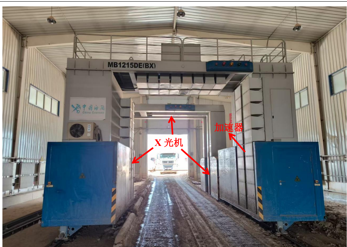
图 9-1 MB1215DE (BX) 集装箱/车辆检查系统正面外观示意图
