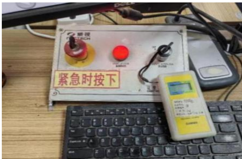
图 10-5 同类型检查系统控制台上安全联锁开关示意图
