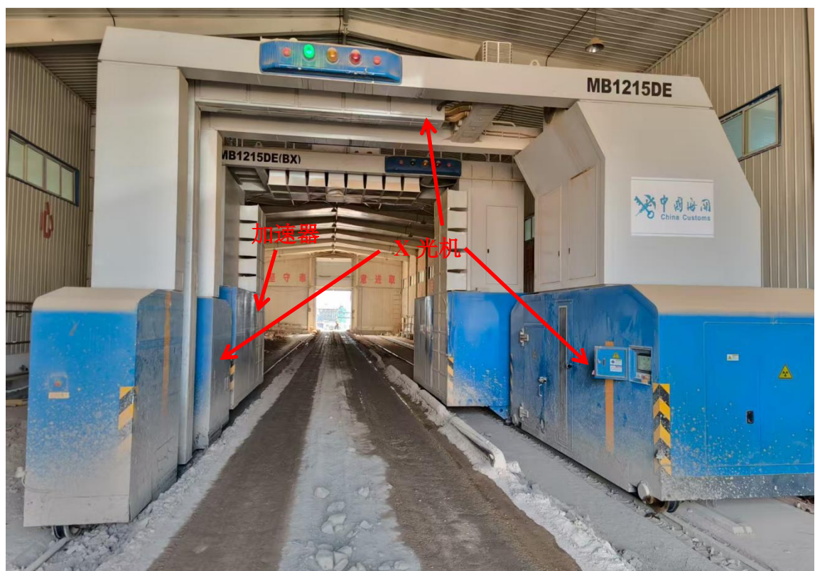
图 9-2 MB1215DE (BX) 集装箱/车辆检查系统背面外观示意图
