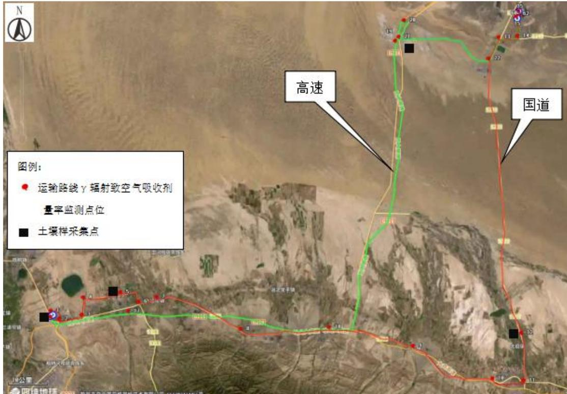
图 4-3 运输路线（比选线路一和二） $\gamma$  辐射致空气吸收剂量率监测及土壤样采集布点示意图
