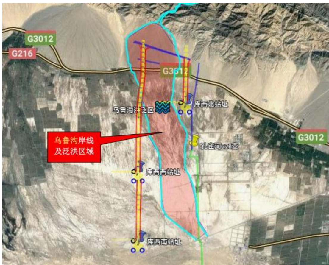
图 4.2-3 乌鲁沟岸线与线路相对位置示意图
