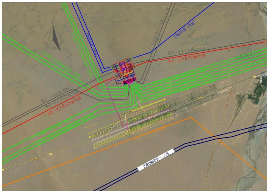
图 3.1-3 民丰 750kV 变电站出线规划图
