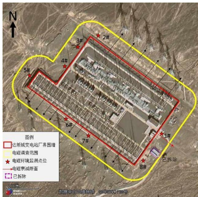
图 6.1-1 达坂城 750kV 变电站监测点位示意图
