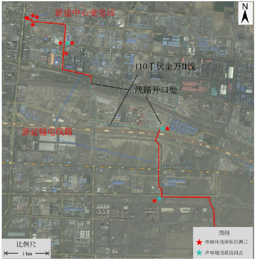
图 3-11 本项目拟新建输电线路监测点位布设示意图
