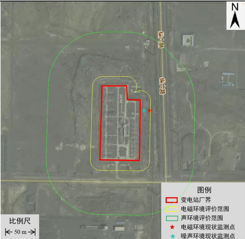
图 3-10 本项目拟扩建崇光 220 千伏变电站监测点位布设示意图
