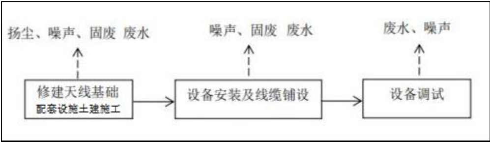
图 2-1 施工期工艺流程及产污节点图
