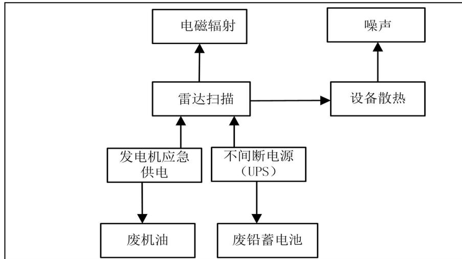
图 2-2 运营期工艺流程及产污节点图
