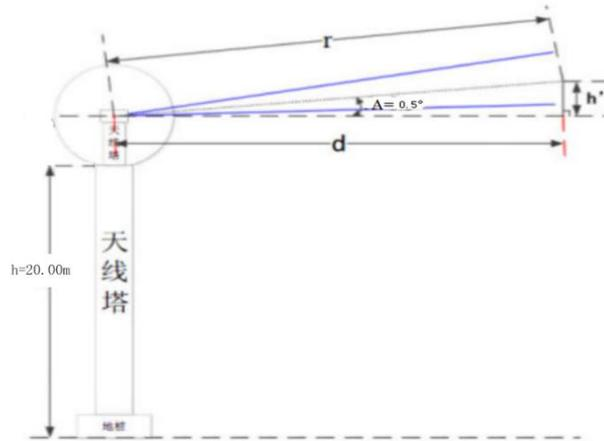
图 4-1 天线前方限高计算示意图
