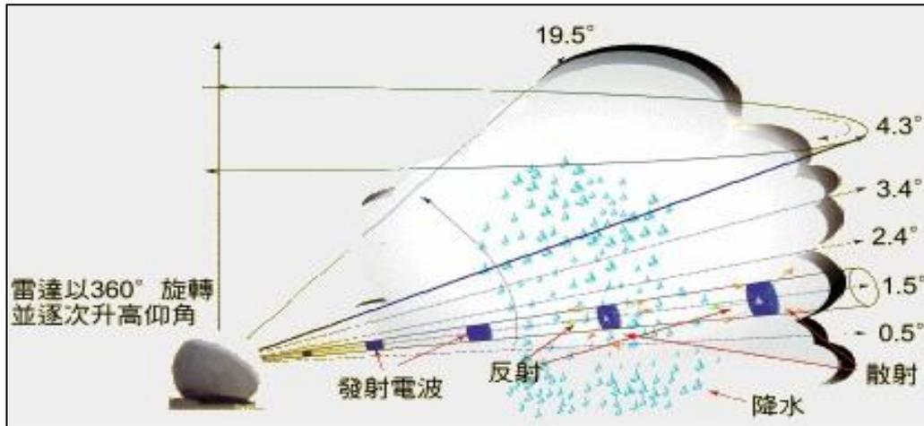
图 2-3 X 波段气象雷达系统工作原理图
