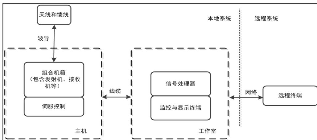
图 2-4 X 波段气象雷达系统组成示意图
