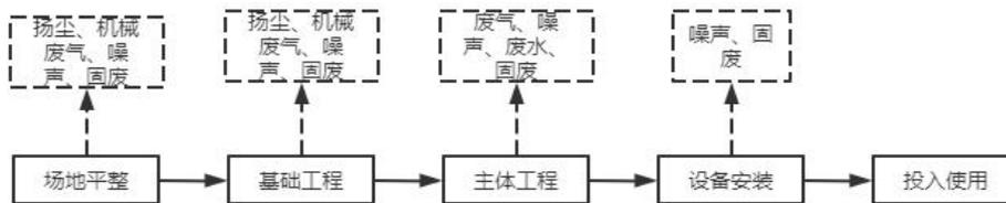
图 2-1 施工期工艺流程及产污节点图
