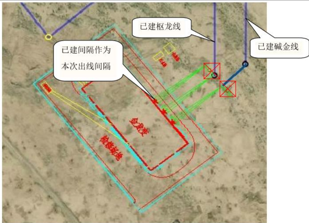
图 2-7 110kV 金龙变出线示意图
