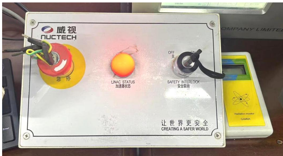
图 10-4 检查系统控制台上安全联锁开关示意图
