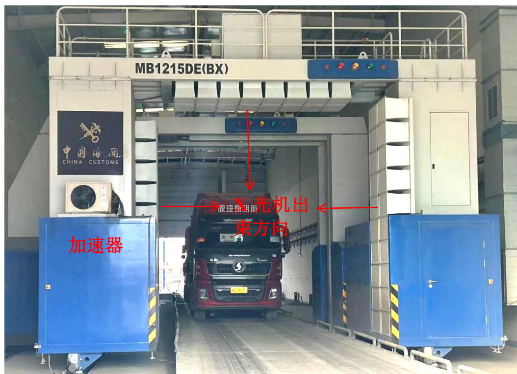
图 9-1 MB1215DE (BX) 组合移动式集装箱/车辆检查系统外观示意图
