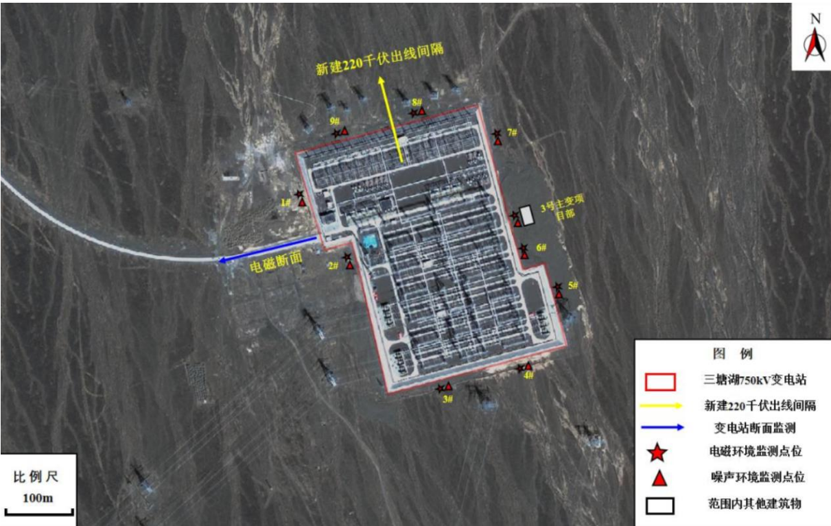
图 6-1 三塘湖 750kV 变电站厂界及断面电磁环境监测点位示意图
