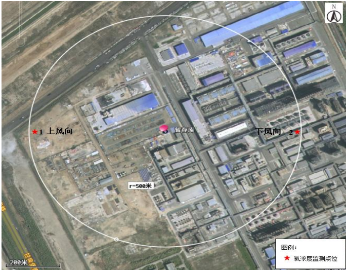
图 4-3 暂存库外上、下主导风向（500m 范围内）氡浓度监测布点示意图（补充监测）
