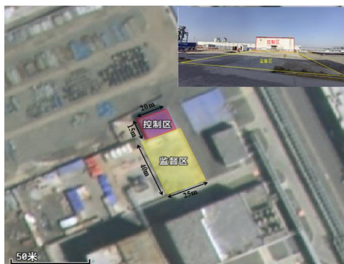
图 5-2 伴生放射性废渣预处理、装载与清污阶段作业场所分区示意图
