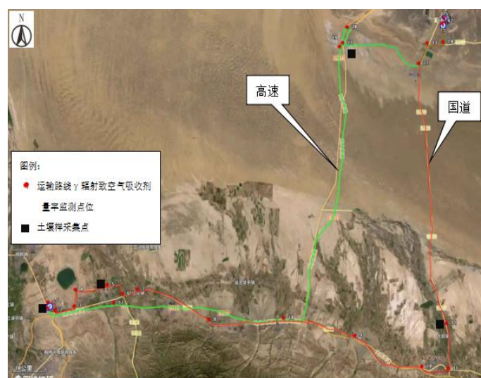
图 4-4 运输路线（比选线路一和二） \gamma 辐射致空气吸收剂量率监测及土壤样采集布点示意图
