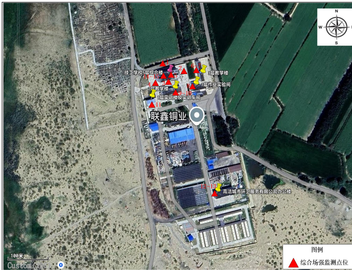
图4-1 电磁辐射监测布点示意图
