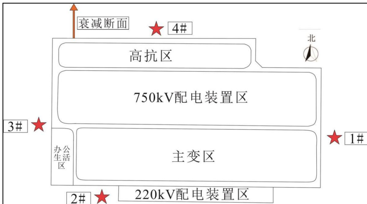
图 6.1-1 五家渠 750kV 变电站监测点位示意图
