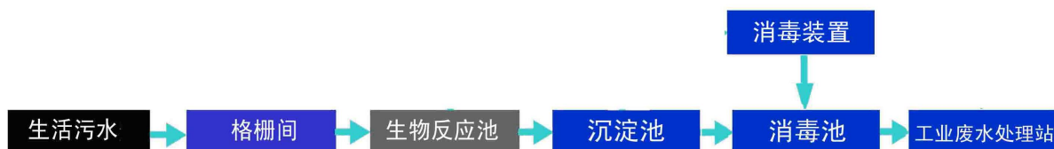
图 2-5 生活污水处理工艺流程图
