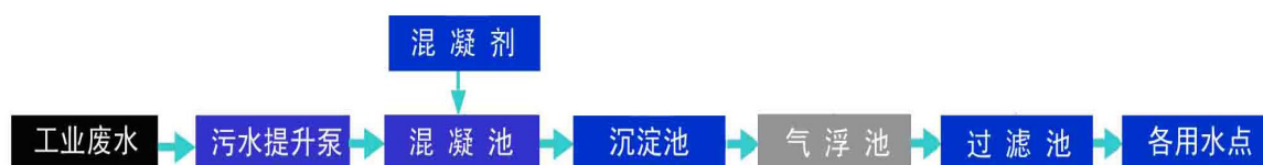
图 2-4 工业废水处理工艺流程图
