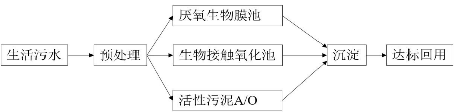
图 2 二级排放标准处理设施工艺组合图
