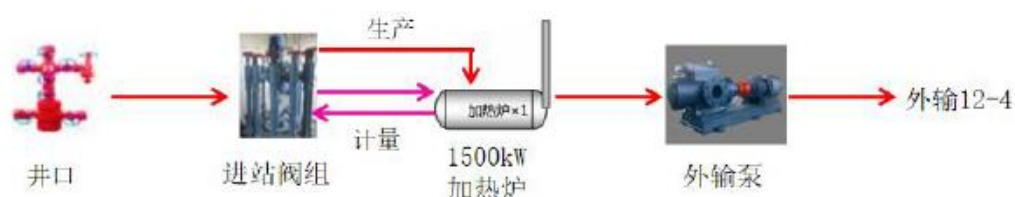
图 3.3-7 YQ5 混输泵站工艺流程示意图
