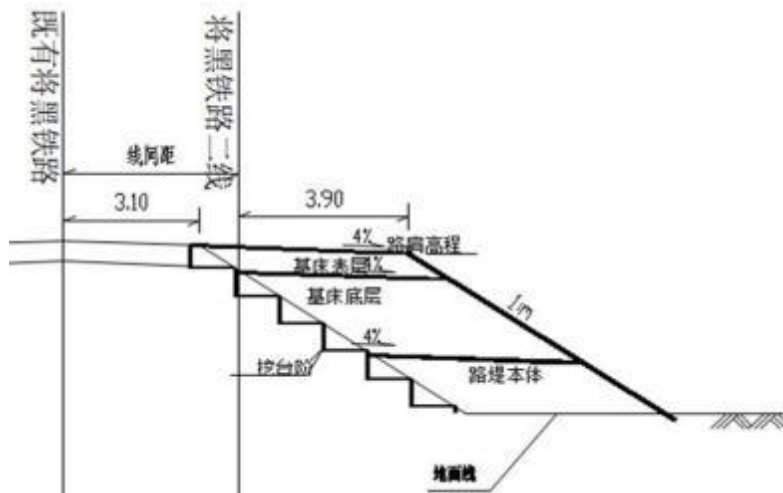
图3.2-3路堤段增二线标准断面图
