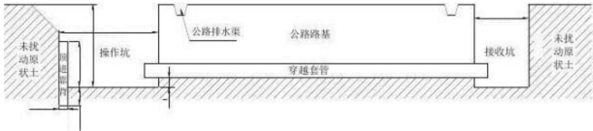
图3.4-4 穿越沥青道路施工作业示意图
