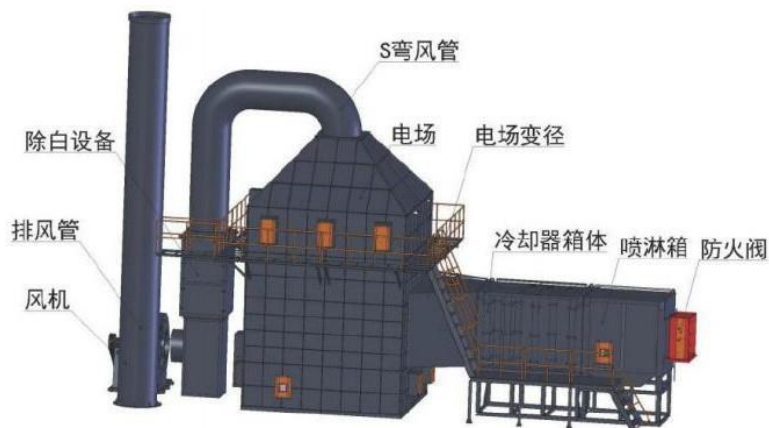
图 7.2-3 “水喷淋+间接冷却+静电净化”设备示意图
