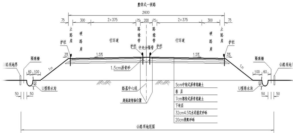
利用原有二级路加宽为整体式一级路及新建整体式一级路，路基宽度为 26m。其路基断面布置为：行车道宽  $4 \times 3.75\text{m}$ ，中间带宽 3.5m, 右侧硬路肩宽  $2 \times 3\text{m}$ ，土路肩宽  $2 \times 0.75\text{m}$ 。新建整体式路基路面单向横坡 1.5% 坡向外侧，土路肩双向横坡 3%。
