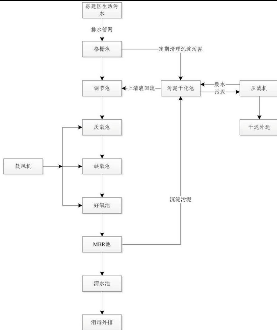
图 6.3-2 一体化污水处理设施工艺流程（MBR 法）
