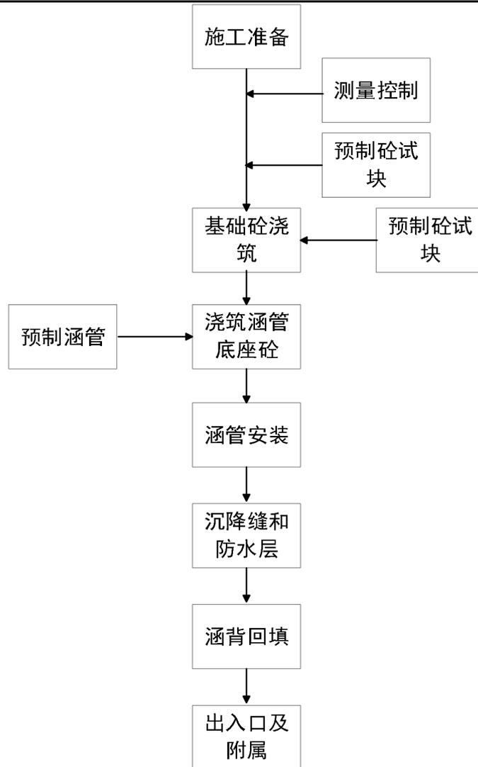
图 3.3-6 圆管涵施工工艺流程图
