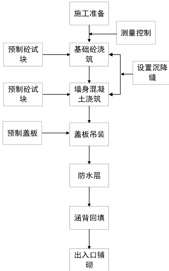
图 3.3-5 盖板涵施工工艺流程图
