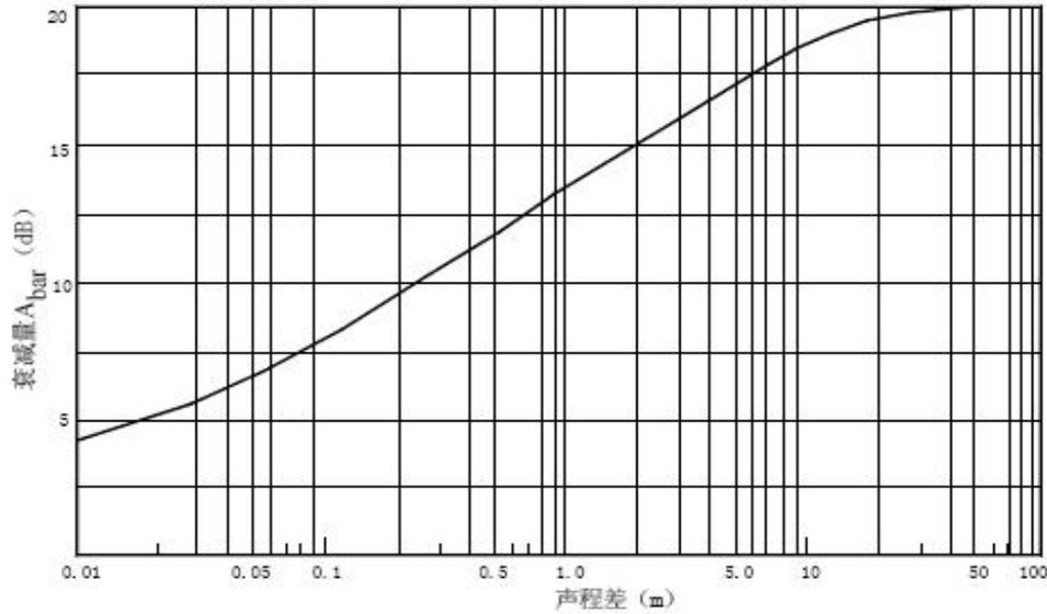
图 5.2-4  $\Delta L_2$  声影区与 $\delta$ 的关系曲线
