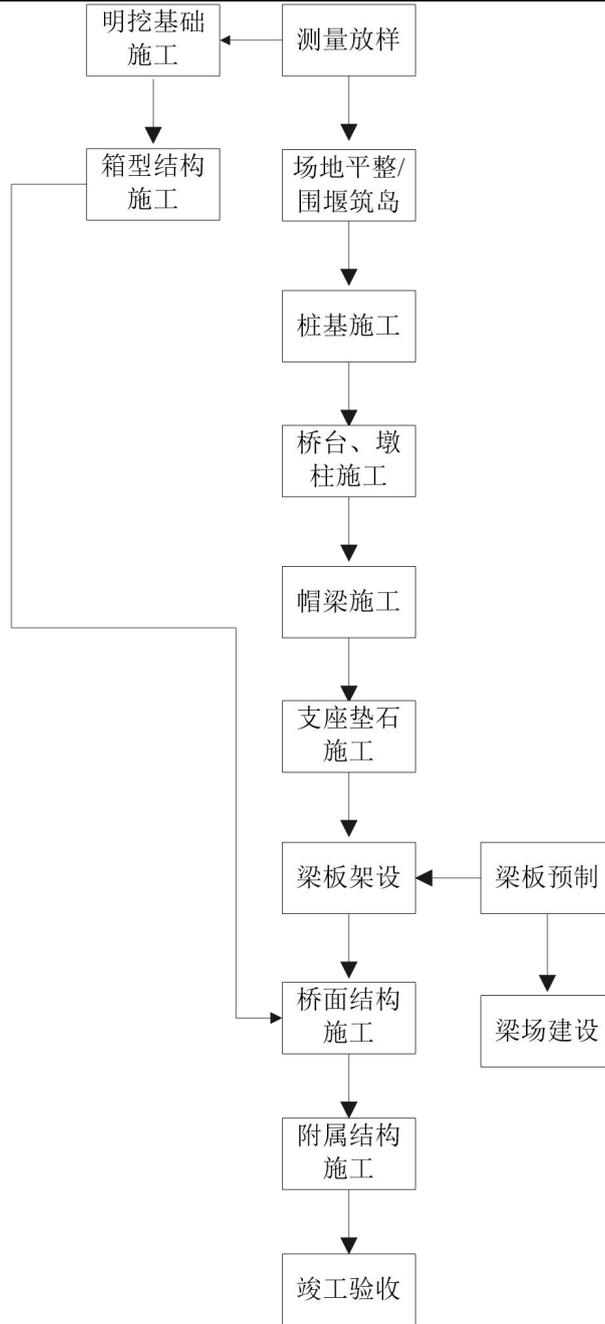
图 3.4-4 桥梁施工工艺流程图
