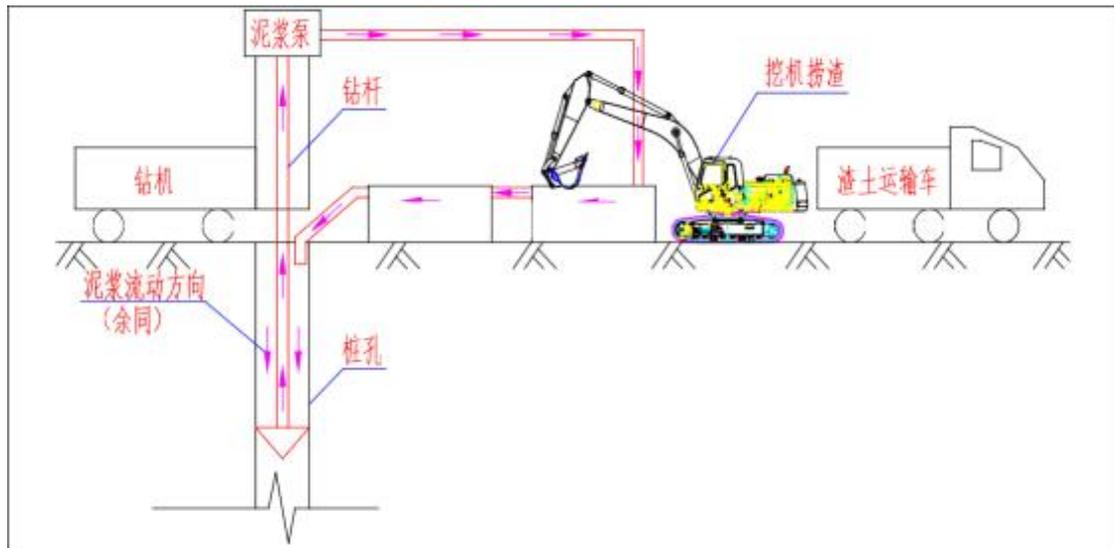
图 6.3-1 泥浆循环系统示意图
