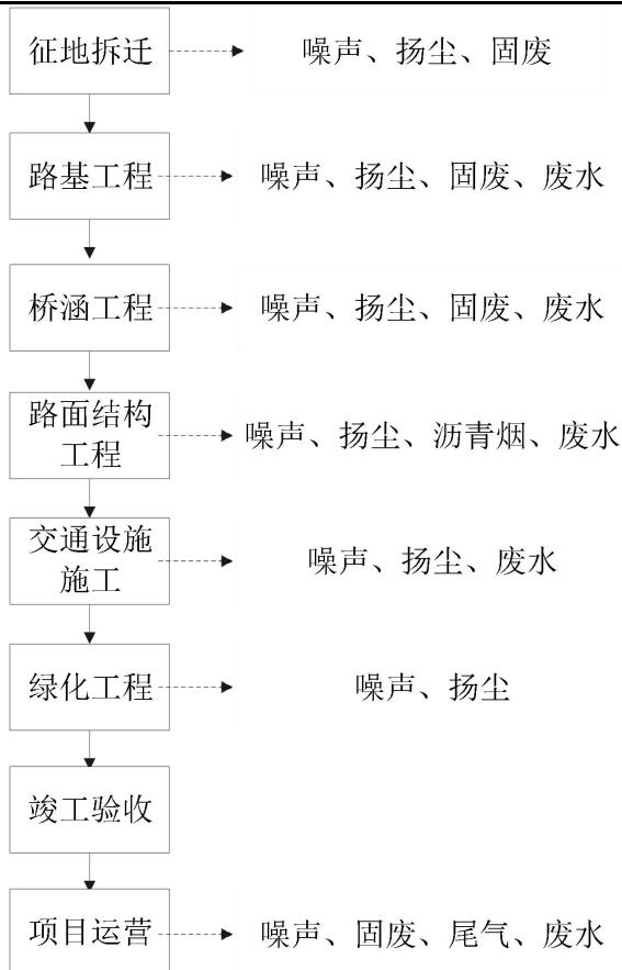
图 3.3-1 道路工程工艺流程及产污节点图
