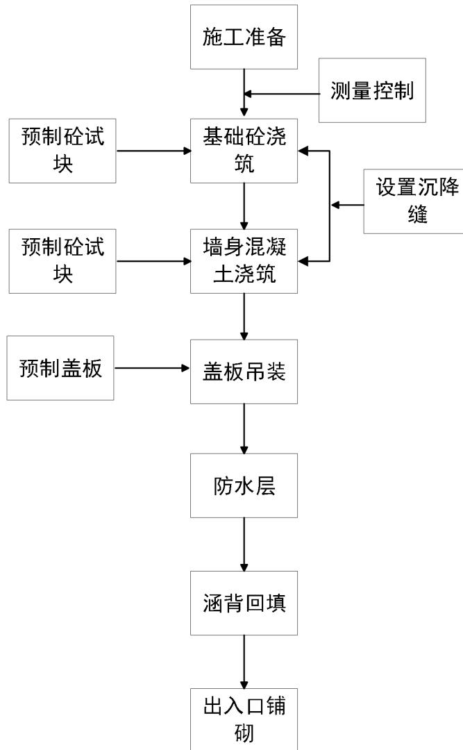
图 3.3-5 盖板涵施工工艺流程图
