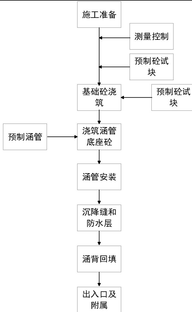
图 3.3-6 圆管涵施工工艺流程图
