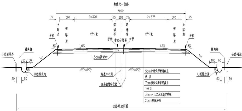
利用原有二级路加宽为整体式一级路及新建整体式一级路，路基宽度为 26m。其路基断面布置为：行车道宽  $4 \times 3.75\text{m}$ ，中间带宽  $3.5\text{m}$ ，右侧硬路肩宽  $2 \times 3\text{m}$ ，土路肩宽  $2 \times 0.75\text{m}$ 。新建整体式路基路面单向横坡  $1.5\%$  坡向外侧，土路肩双向横坡  $3\%$ 。
