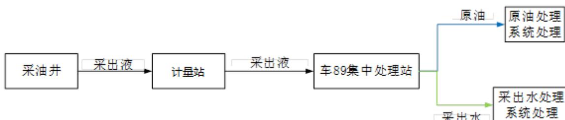
图 3.5-2 本工程集输系统流程
