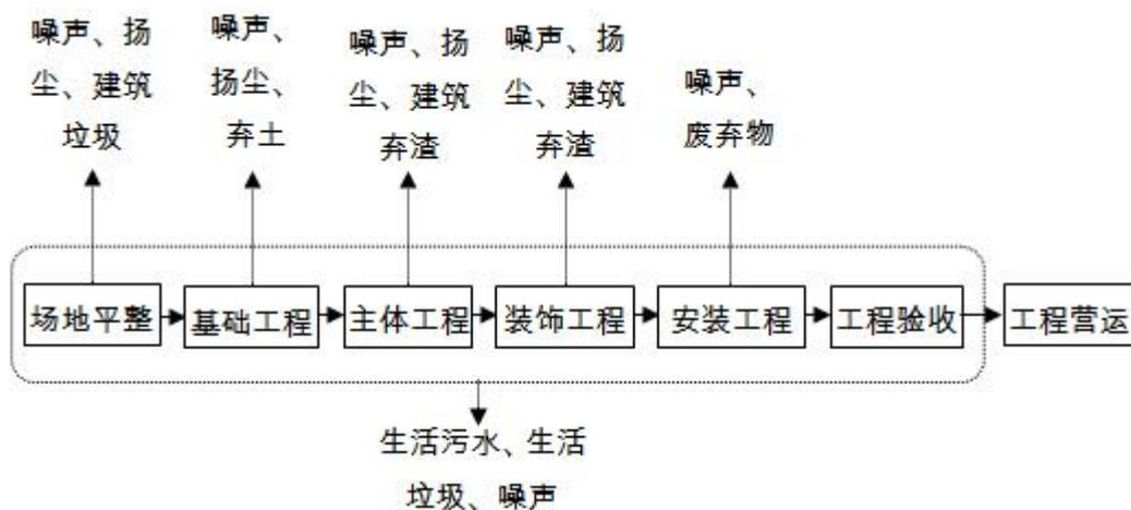
图 5.1-1 施工工艺流程及产污环节
