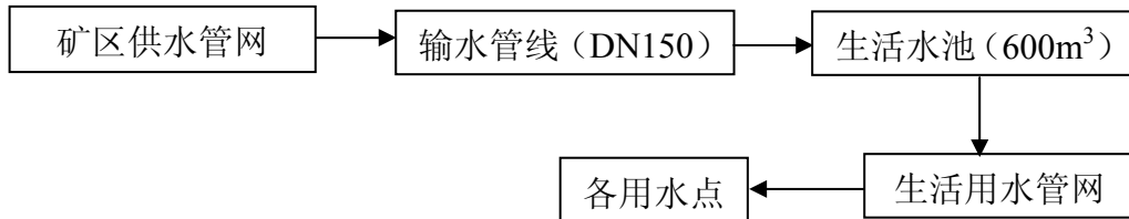
图 2.3-5 生活供水系统工艺流程图
