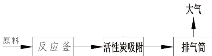
图 6-2-1 废气处理工艺流程图
