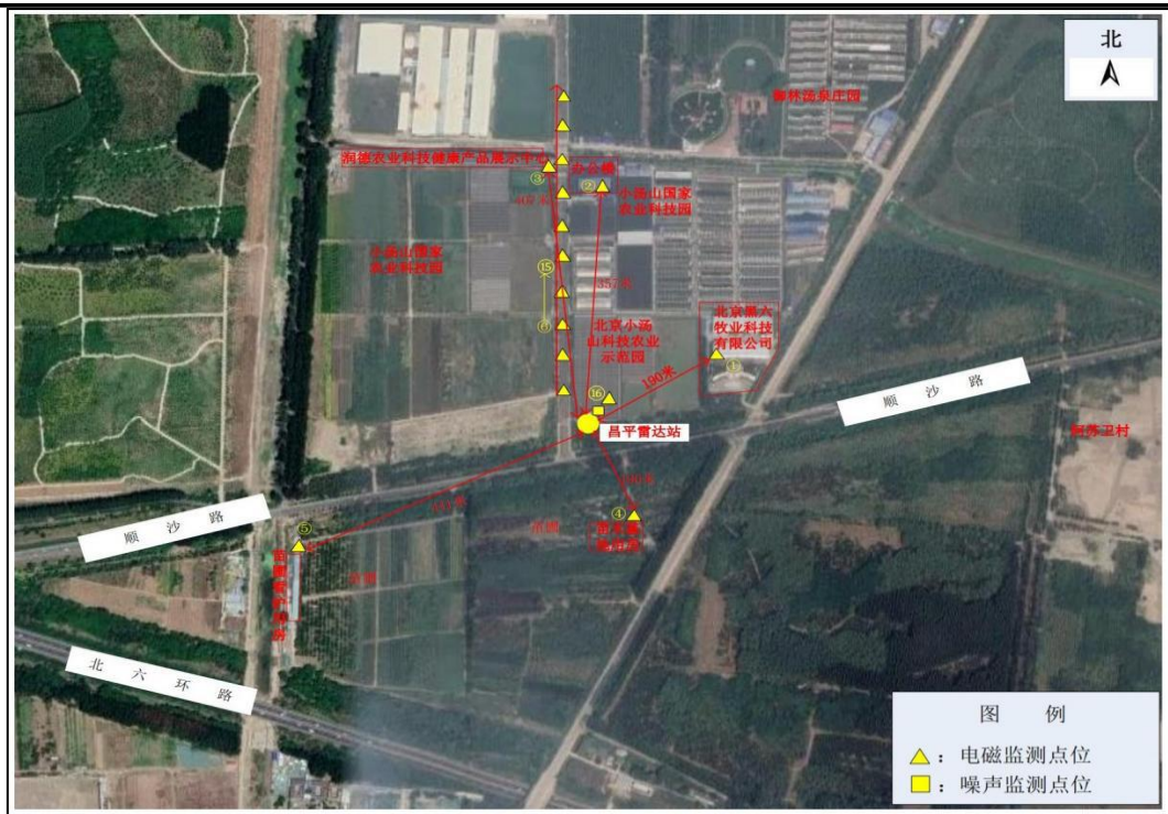
图 6-3 昌平雷达站检测布点图
