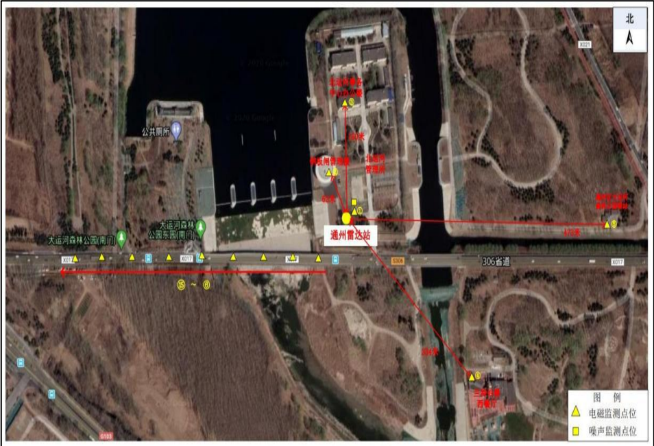
图 6-2 通州雷达站检测布点图
