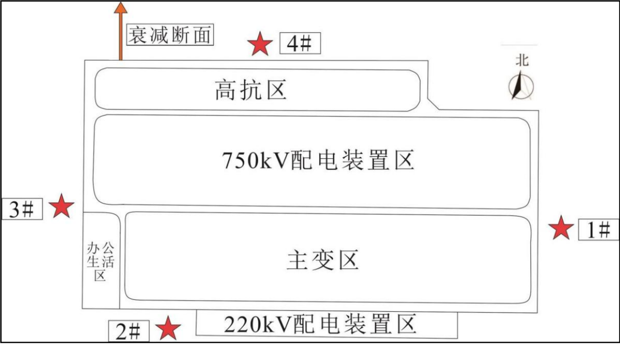
图 6.1-1 五家渠 750kV 变电站监测点位示意图
