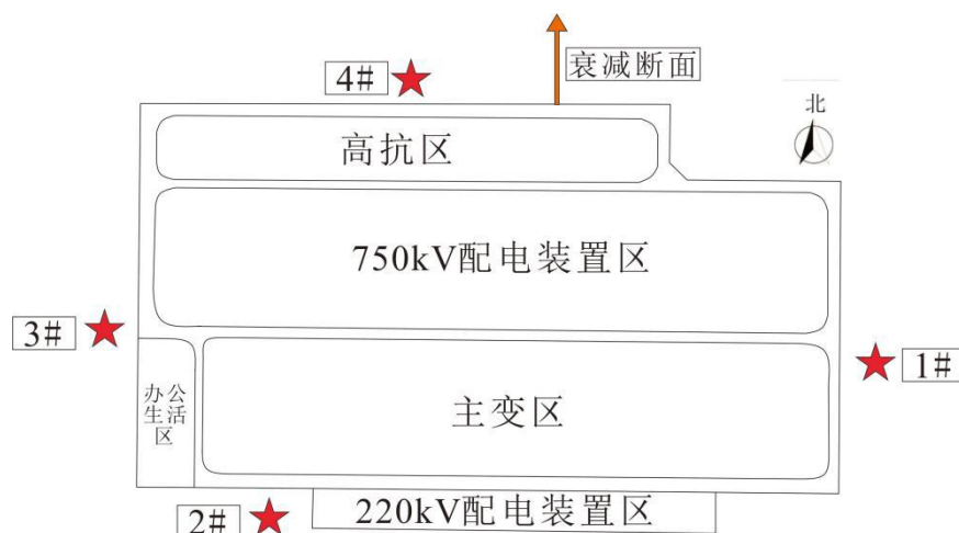
图 6.1-1 五家渠 750kV 变电站监测点位示意图
