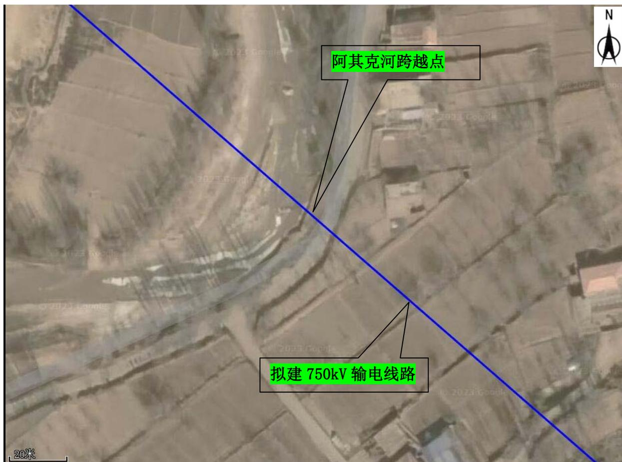
图 4.1-2 输电线路跨越阿其克河跨越点
