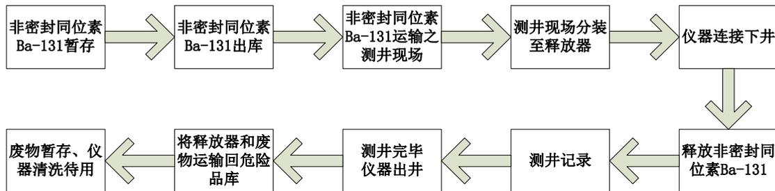
图 9-8  $^{131}\text{Ba}$ 同位素测井工艺流程
