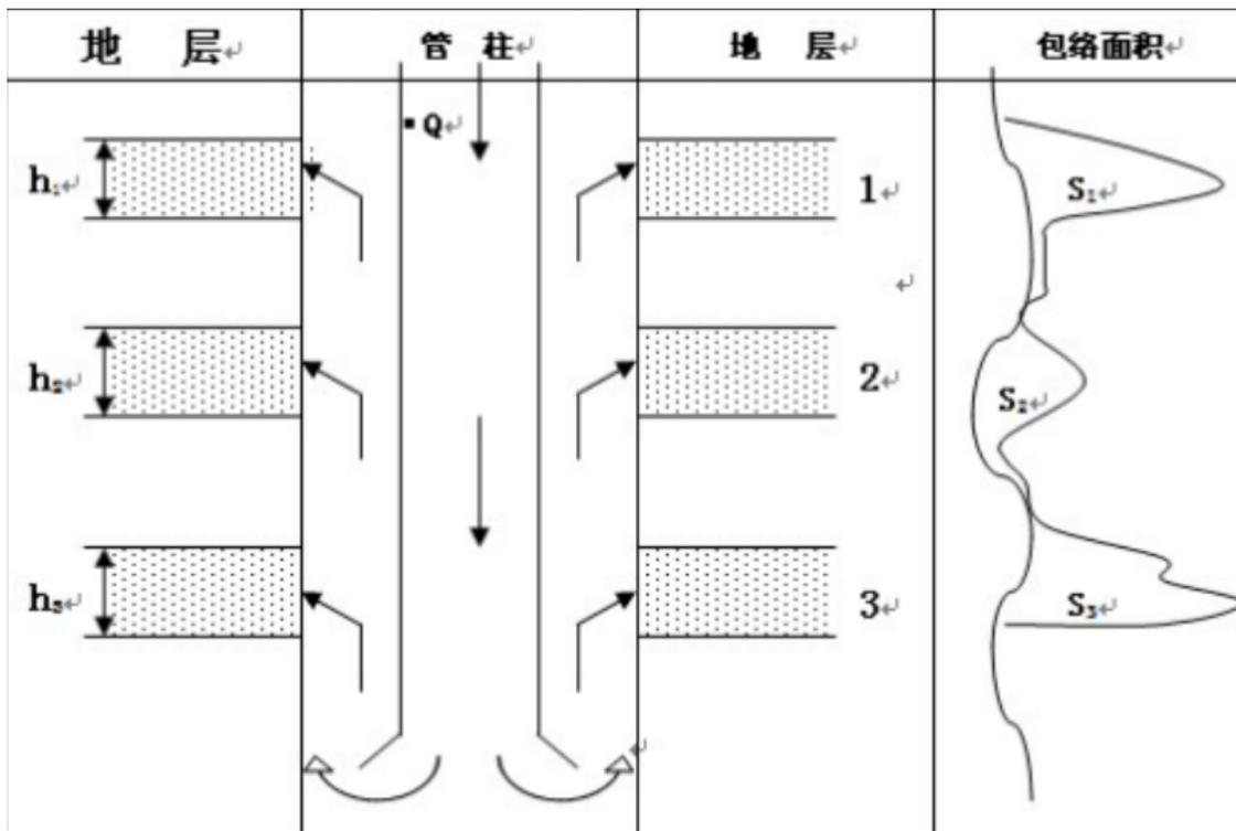
图 9-6 放射性同位素测井原理示意图
