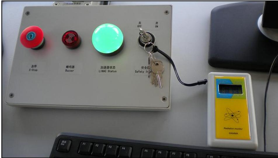
图 10.4-2 系统控制台上安全联锁开关
