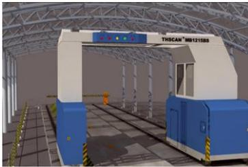
○ 系统上电，加速器完成预热，系统进入就绪状态。
