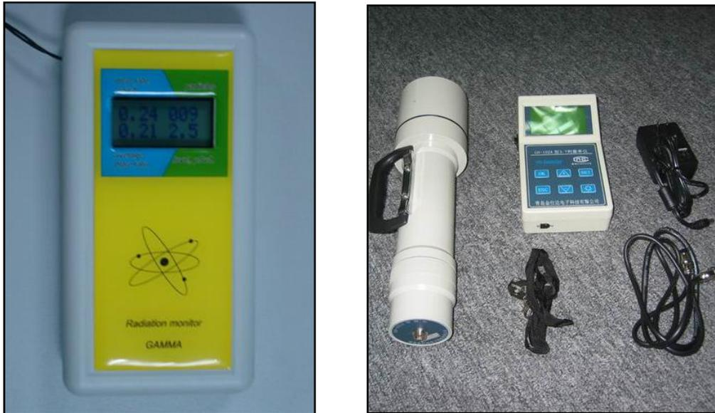
图 10.4-10 个人剂量报警仪和环境 X、 $\gamma$ 剂量率仪
