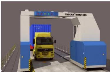
○ 集装箱卡车停稳后，司机下车，离开控制区域，系统准备扫描。
