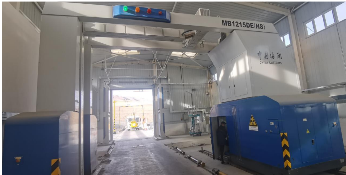
图 9-1 MB1215DE (HS) 集装箱/车辆检查系统外观示意图
