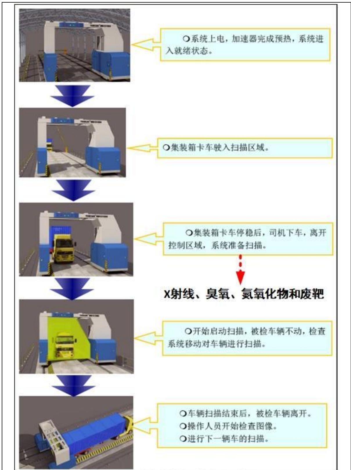
图 9-5 同类型集装箱/车辆检查系统精细检查模式下的工作流程示意图
