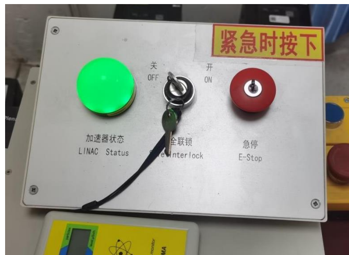
图 10-7 同类型检查系统控制台上安全联锁开关示意图
